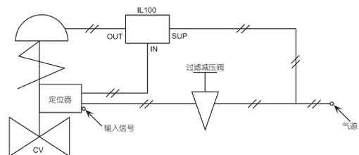
图 1 IL 100 型的安装示例
